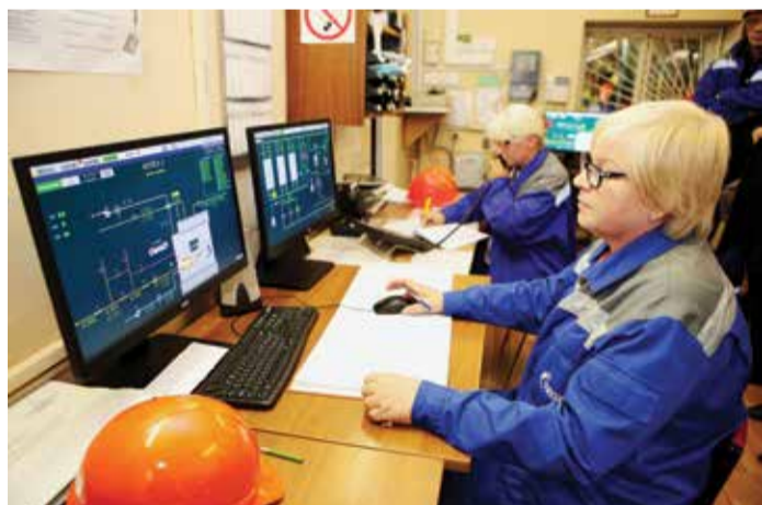
Отличительной особенностью системы экомониторинга ПАО «МОЭК» является возможность не только наблюдать за составом выбросов, но и через АСУ ТП влиять на процесс сжигания топлива и оптимизировать работу оборудования. На фото – машинист котлов Алла Иванникова и начальник смены Наталья Русина
