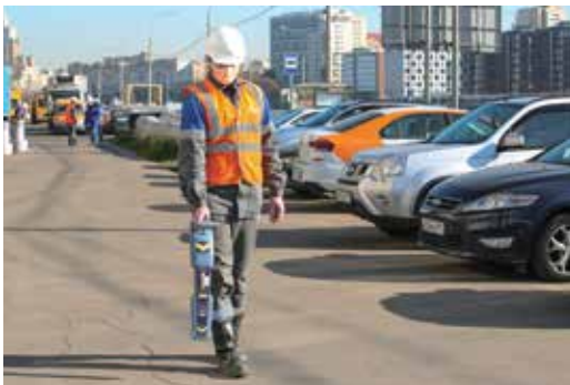
Использование теческатора позволяет точнее определить место повреждения
